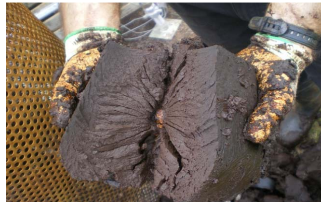
EK dewatering 20-30% ds
